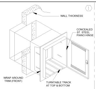
INSERT TURNTABLE BOX INTO WALL OPENING WITH WRAP AROUND TRIM ALREADY ON UNIT
